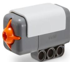
Этот датчик, по сути, представляет собой специальную кнопку, которая может находиться в двух состояниях: "Нажатие" или "Освобождение". Также, последовательный переход в состояние "Нажатие", а затем "Освобождение" называется: "Щелчок" и может обрабатываться программой, как самостоятельное событие.
