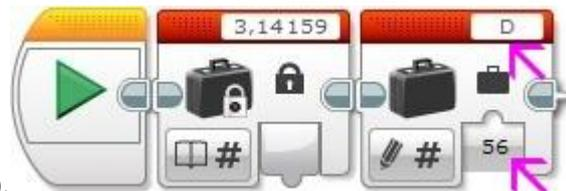
3. Используя программный блок "Математика", умножим значение блока "Константа" на значение переменной **D**. Для передачи значения из переменной **D** в программный блок "Математика" используем второй программный блок "Переменная" в режиме "Считывание"! (Для передачи значений между программными блоками используются шины
